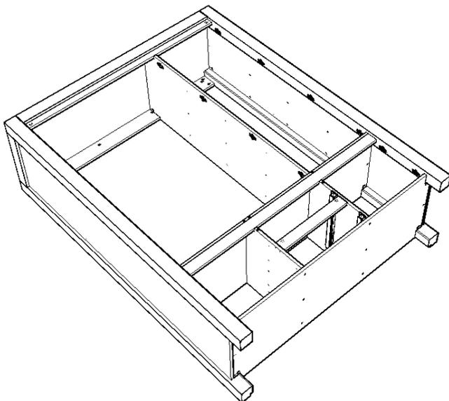
**ШАГ 7.** Перевернуть шкаф задней стороной вверх и прикрепить заднюю стенку, предварительно проверив соответствие угла 90 градусам, путем замера диагоналей.
