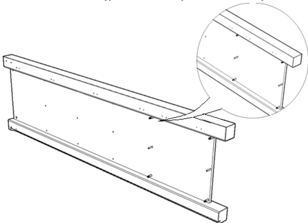
**ШАГ 2.** Соединить с помощью шкантов и эксцентриков внутренние детали шкафа
