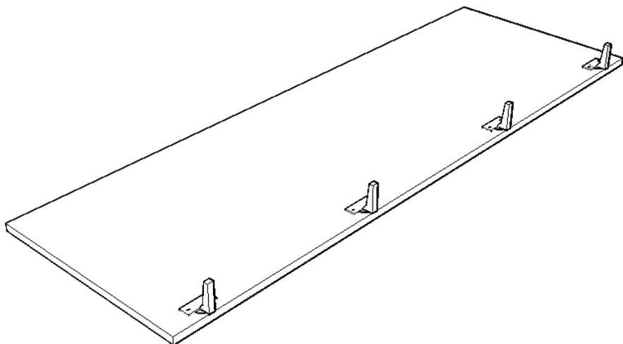
ШАГ 10. Установить шкаф на его постоянное место, установить полки на полкодержатели, вставить ящики и закрепить штангу.
