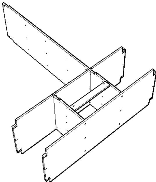
**ШАГ 3** Установить поперечные декоративные планки. Планки 1 крепятся с помощью эксцентриков и шкантов, а планки 2, с помощью уголкоы №292 и саморезов 3,5x16.
