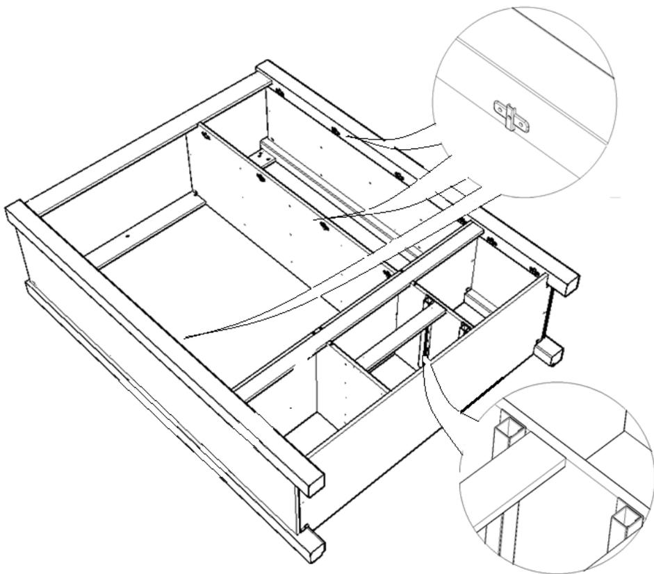
**ШАГ 5.** Вставить шканты и вкрутить эксцентрики в соответствующие отверстия на крышке.
