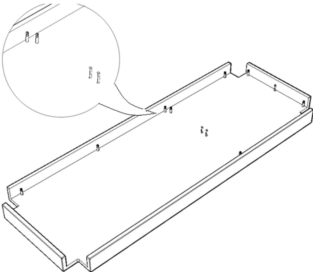
**ШАГ 6.** Надеть крышку и затянуть эксцентрики.
