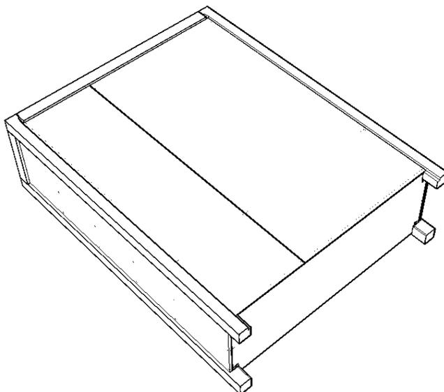
**ШАГ 8.** Собрать ящики с помощью шкантов и евровинтов, прибить дно гвоздями и прикрепить замки направляющих саморезами 3,5x16.
