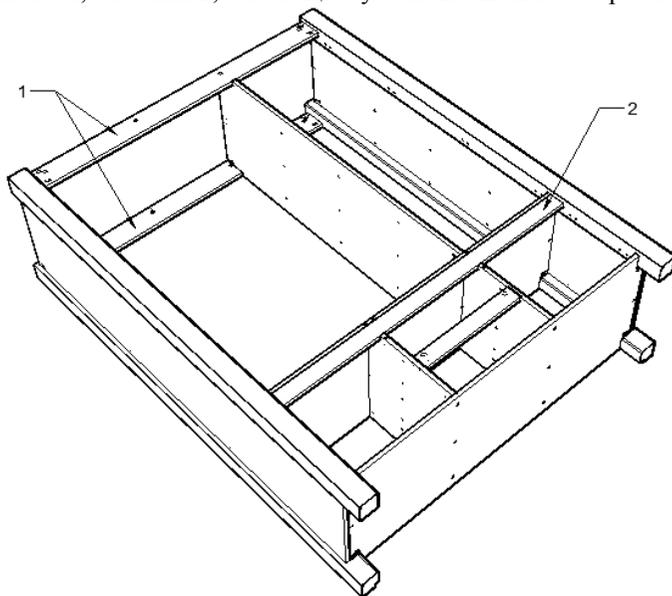
**ШАГ 4.** Установить ответные планки для петель, закрепив их саморезами 3,5x16 по мет., отгалкиватели и направляющие. (Направляющие крепить в нижний ряд отверстий винтами 6,3x10,5).
